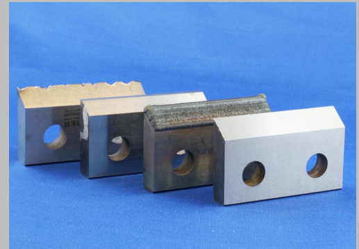
Reparaturschweißen von Schneid- messern aus Werkzeugstahl
