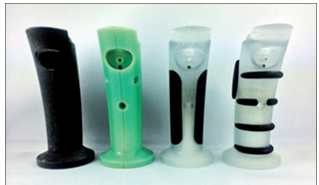
Abb. 1: 3D gedruckte Prototypen eines Joysticks zur Bedienung eines MRT-Gerätes in der Medizintechnik. Es wurden verschiedene Designs und Materialien zur Optimierung angewendet.
